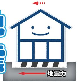
地盤と建物との間にローラーなどの免震装置を設置し地面と建物を切り離して、地震の揺れを建物へ伝えないものです。
