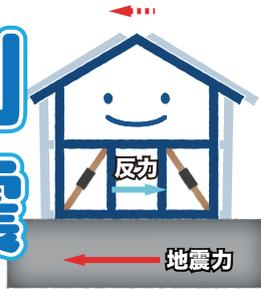
ダンパーなどの制振装置を設置して、建物に伝わる地震の揺れを吸収しながら揺れを小さくし建物のダメージを減らすものです。
